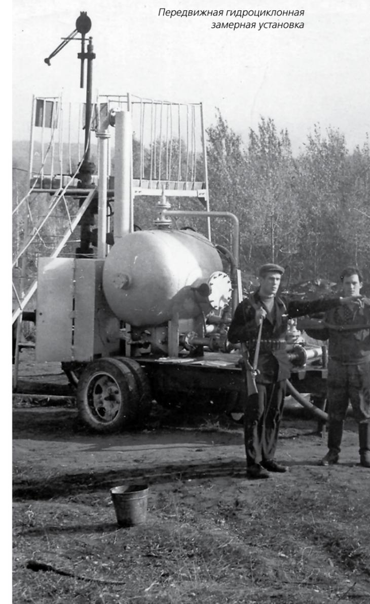
Передвижная гидроциклонная замерная установка
